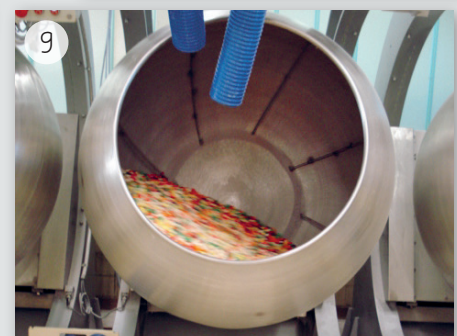
9 Schlussendlich wird ein Lack hinzugefügt, der sich nach kurzer Zeit erhärtet.
